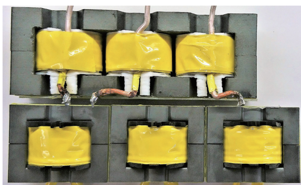
図5 トランス比較写真 Fig. 5 Comparison of the transformers.
